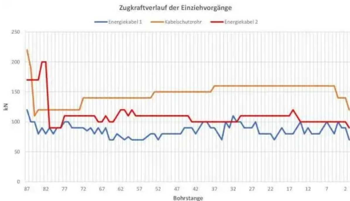
Abb.14: Zugkraftverläufe der drei Rohreinzüge | Fotos und Grafiken: Beermann Bohrtechnik
