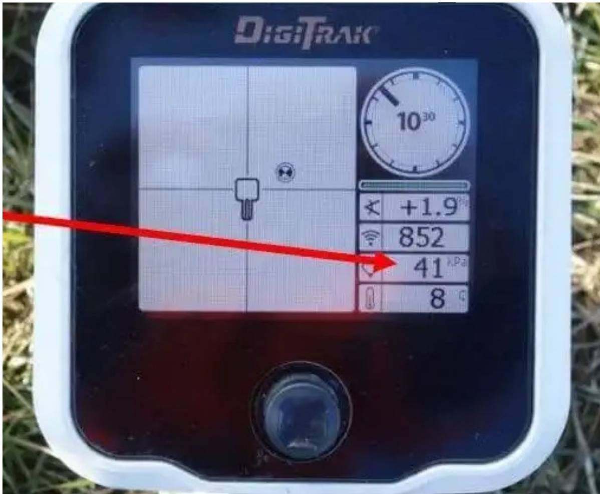
Abb. 5: In ein Walk-Over-System integrierte Messung und Darstellung des Ringraumdrucks
