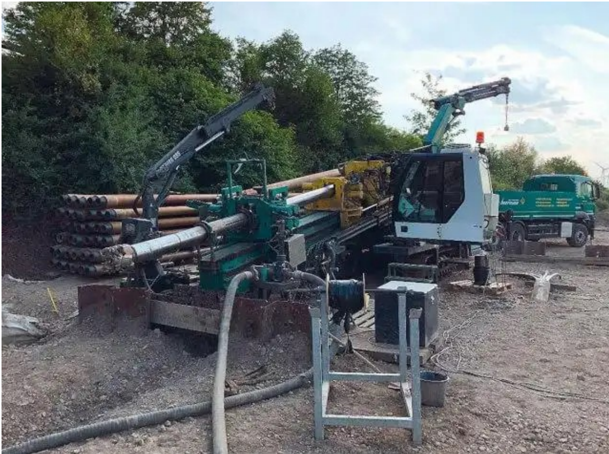
Abb.13: 100-t-Bohranlage PD 100/50 RP
