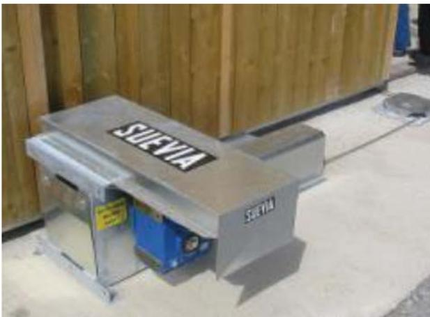
Abb. 16: Seil-Trommel-Antrieb mit
